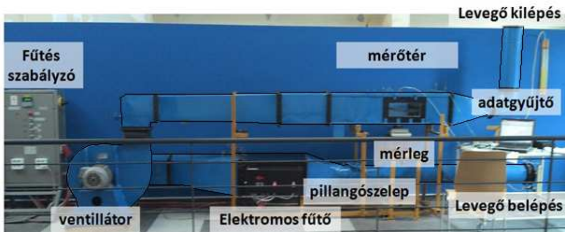
2.3. ábra Félüzemi konvekciós szárító (tanszéki laboratórium)
