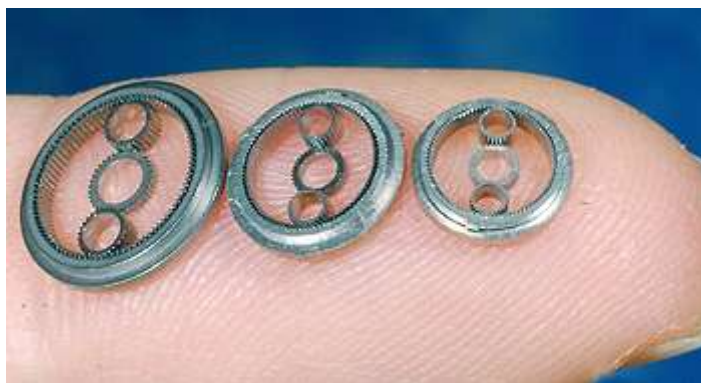
4. ábra: A „legkisebb” hagyományos hullámhajtómű és a mikrohajtómű [4]
