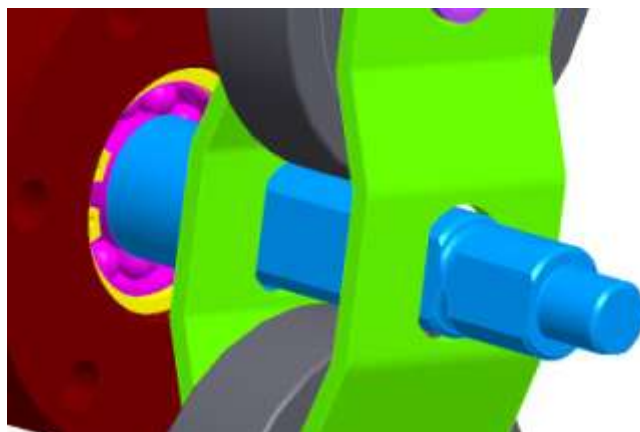
15. ábra: Hullámgenerátor és a behajtó tengely kapcsolata
