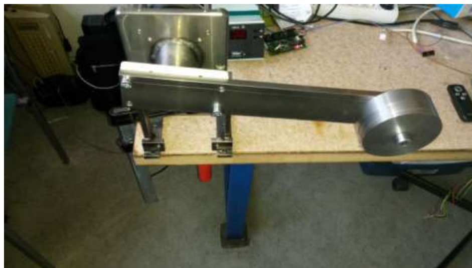
35. ábra: Hajtómű áttételének mérése terhelés alatt
