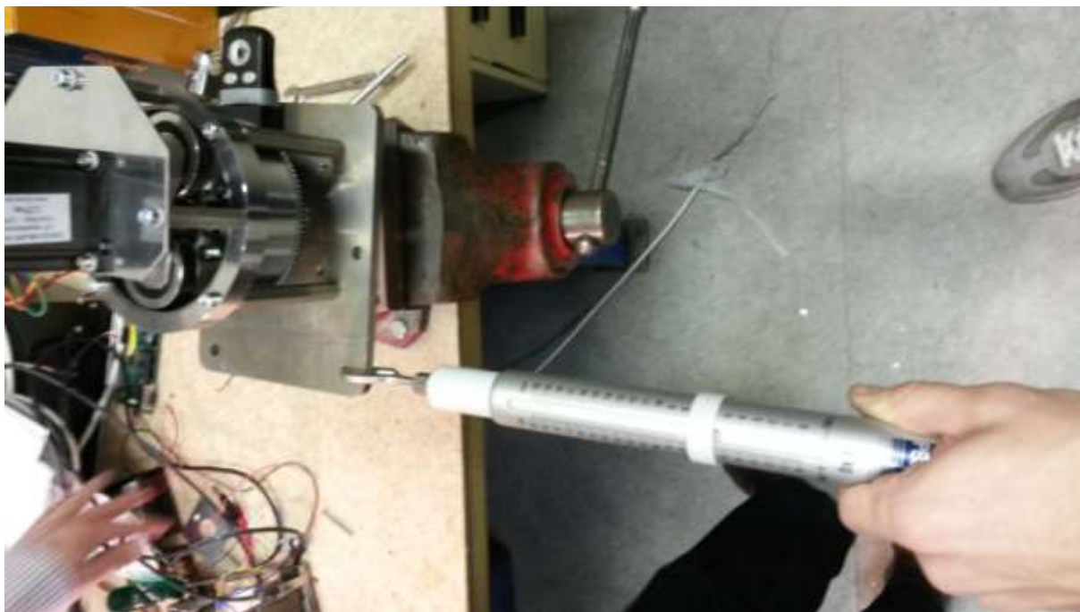
36. ábra: Hajtómű által átvihető maximális nyomaték mérése
