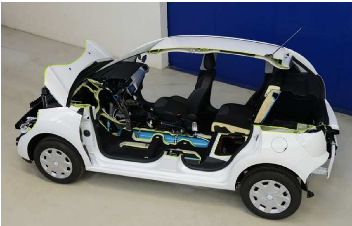
4.3. ábra PSA csoport sűrített levegő-diesel hibridje [7]
