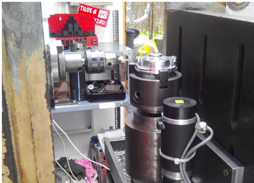
25. ábra Palást furatok elkészítése B-tengellyel
