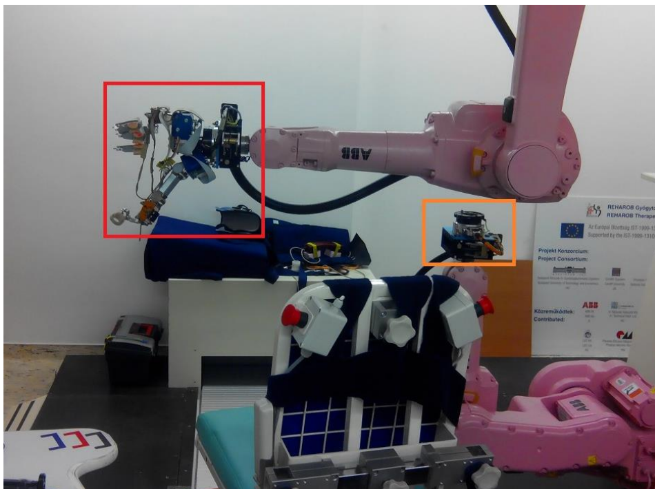
41. ábra Mindkét szenzor alkalmazási környezete (piros keretben a beépített erősítővel rendelkező szenzor, míg narancssárga keretben a beépített erősítőt még nem tartalmazó szenzor látható)
