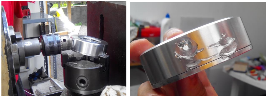
29. ábra A burkolat megmunkálása közben fellépő probléma
