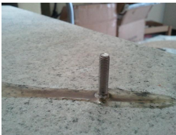
5.4. ábra Munkapult csavarokkal való rögzítésének módszere
