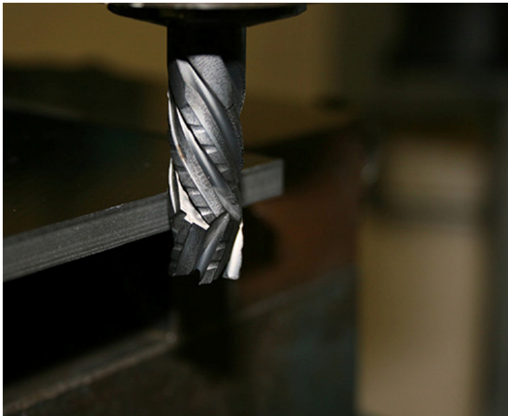
4.13. ábra JC845 nagyoló szerszám forgácstörővel [7]
