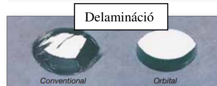
4.23. ábra Csavarvonal interpoláció kontra hagyományos fúrás Conventional: Hagományos; Orbital: Csavarvonal interpoláció [9]
