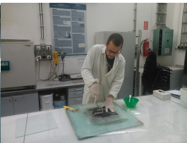
5.3. ábra Laminálás a PTT laboratóriumban
