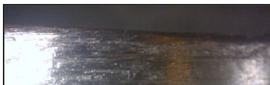
3.13. ábra Ugyanazon furatról készült képek. Belépő él közeli baloldalt és kilépő él közeli felület jobboldalt
