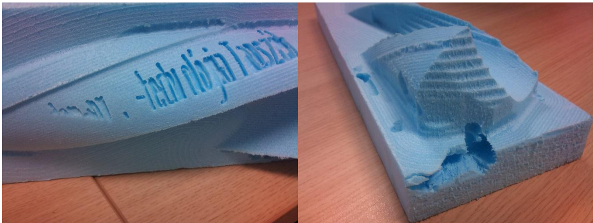
42. ábra: Az orientáció váltásokból származó pontatlanság a munkadarabon
