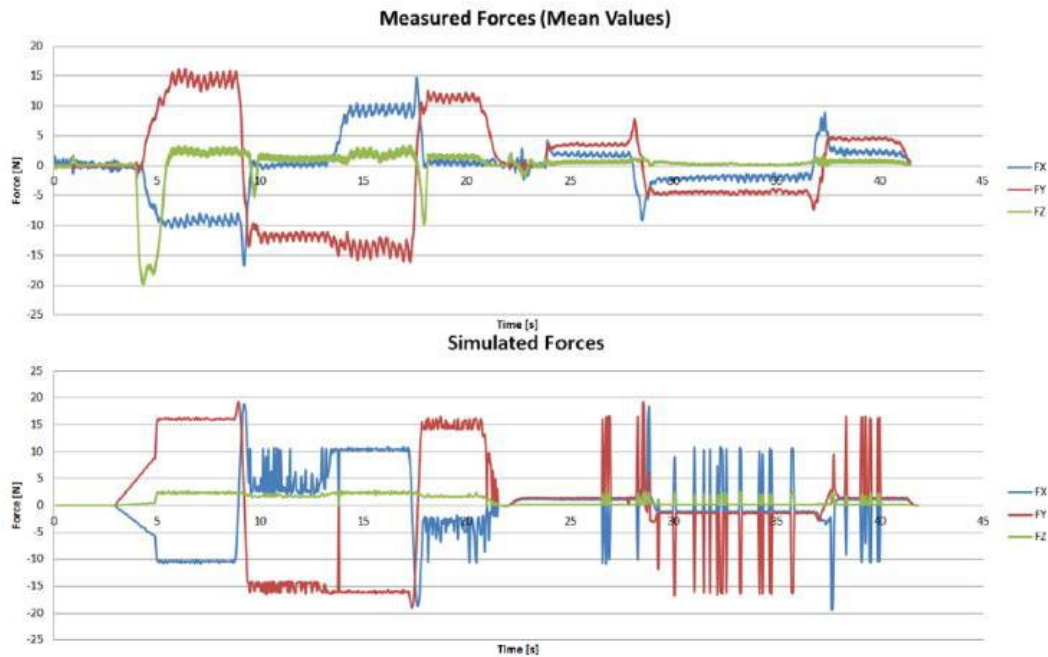
16. ábra: Az off-line módon számított- és az erőmérőcellával mért forgácsolási erőértékek [25]
