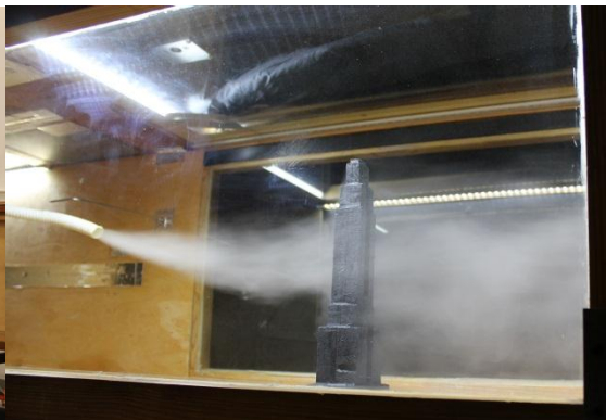
48. ábra: Modell szélcsatornás kísérletekhez
