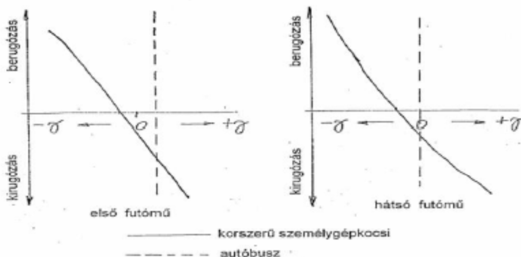
14. ábra A gépjármű kerékdőlés alakulása be- és kirugózáskor Forrás: [28]
