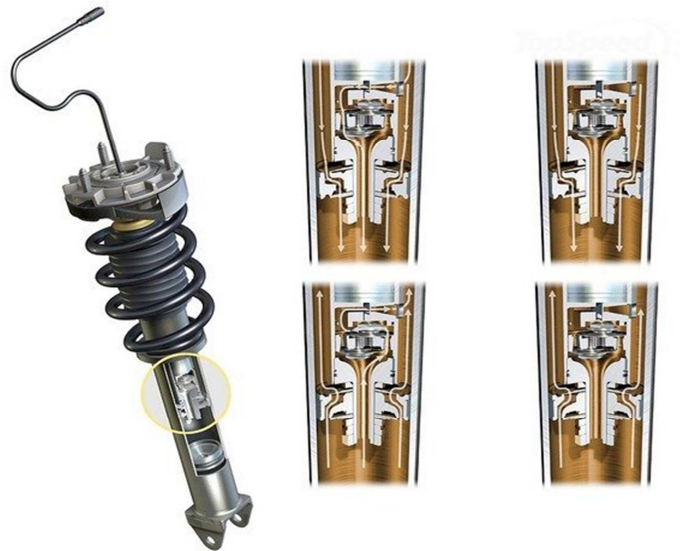
5. ábra A Porsche egy elektronikusan szabályozható lengéscsillapítója Forrás: topspeed.com
