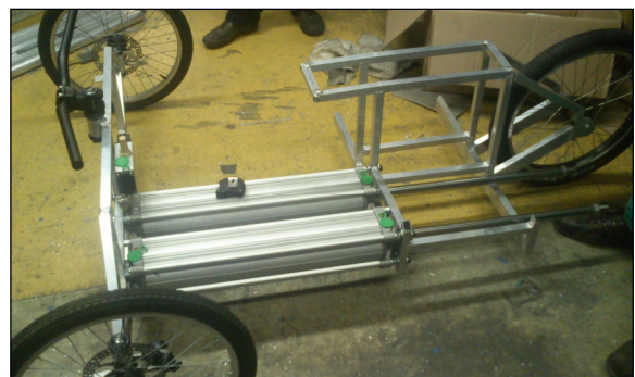
2. kép: Munkahenger beépítése
