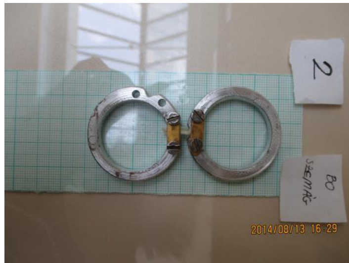
19. ábra: Továbbfejlesztett alumínium befogó alkalmazás közben
