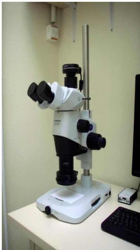
7. ábra: OLYMPUS SZX 16 típusú sztereomikroszkóp
