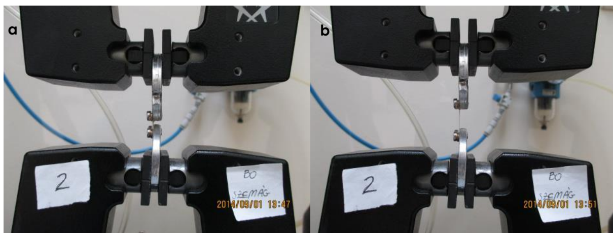
11. ábra: Szakítógépes vizsgálat elvégzése az idegágakon (a – a szakítás elvégzése előtt, b – a szakítás után)
