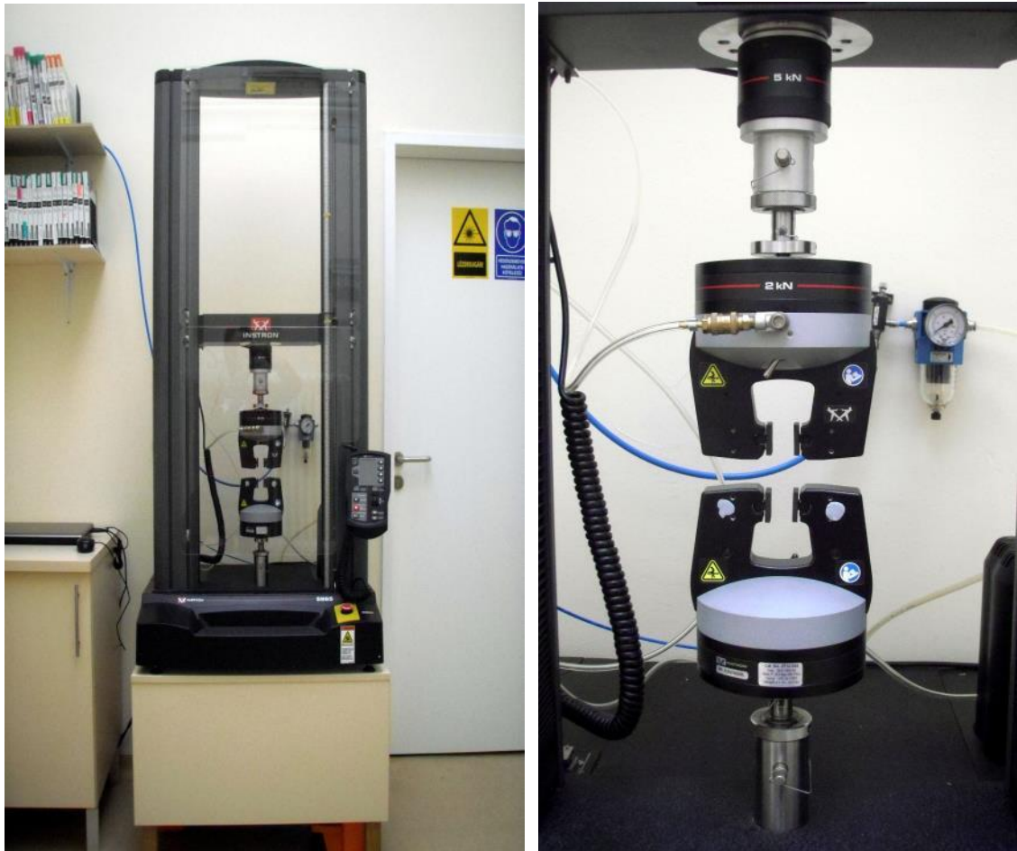
6. ábra: INSTRON 5965 típusú szakítógép
