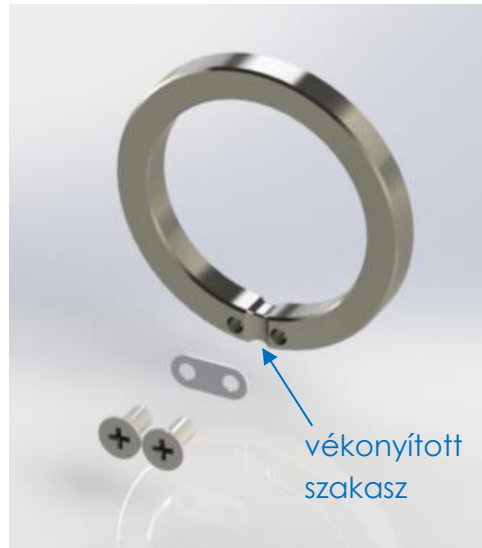
18. ábra: Alumíniumból készített, egy helyen vékonyított befogóról készült fénykép minta befogása után
