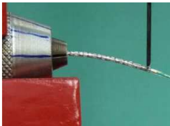
2.16. ábra: Szent-rendszer hajlítása a Szabadíts által tervezett befogó segítségével
