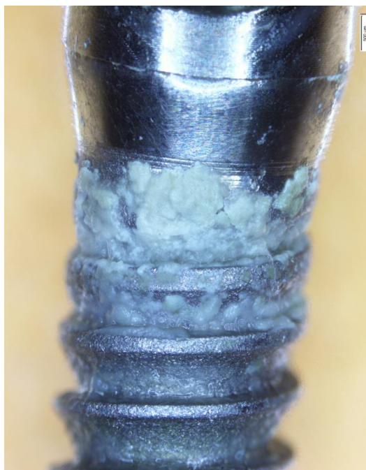
13. ábra: Az ép implantátumon megtapadó csontszövet maradványok
