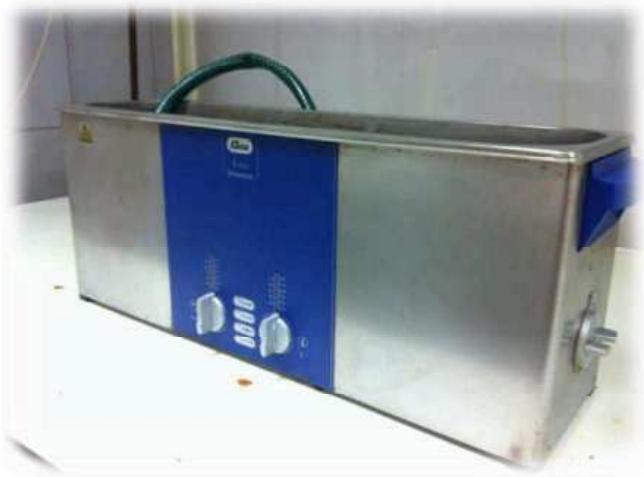
10. ábra A mérés során használt ultrahangos tisztítóberendezés
