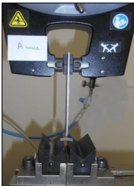
40. Ábra: Minta elhelyezése a hajlítószilárdság vizsgálat során
