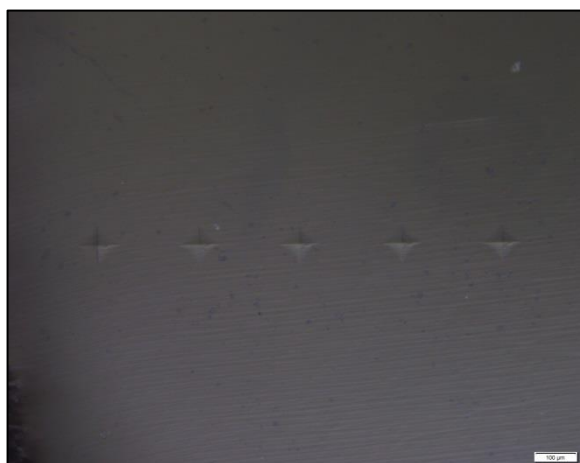
38. Ábra: Keménységmérés során készült lenyomatok a mintában
