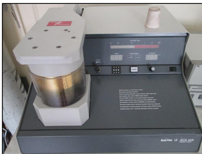
36. Ábra: Aranyozó berendezés (BAL TEK SCD 005)
