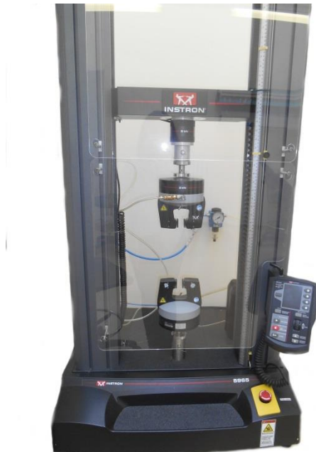
39 Ábra: Szakítóberendezés (Instron 5965)
