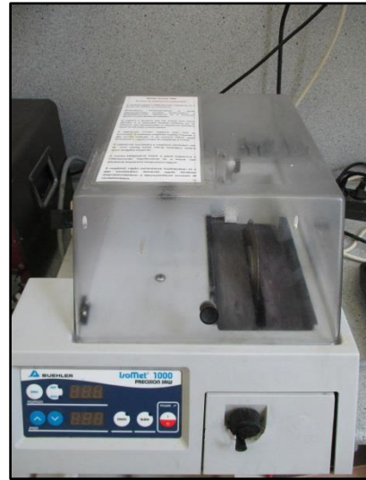
32. Ábra: Gyémánt tárcsás vágóberendezés (Buehler IsoMet 1000)
