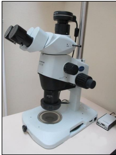
17. ábra: Sztereomikroszkóp (Olympus SZX 16)
