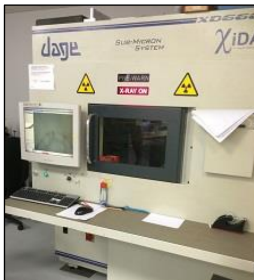
20. Ábra: Röntgenmikroszkóp (Dage Xidat 6600)
