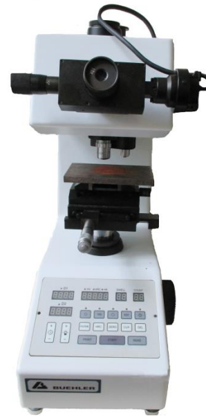
37. Ábra: Keménységmérő (Buehler)
