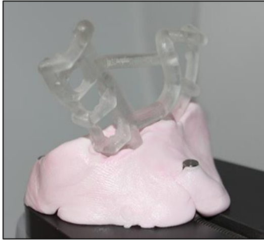
11. ábra: Minta rögzítése az 1-es pozícióban
