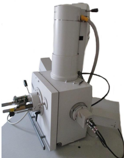
24. Ábra: Pásztázó elektronmikroszkóp (Philips XL 30)
