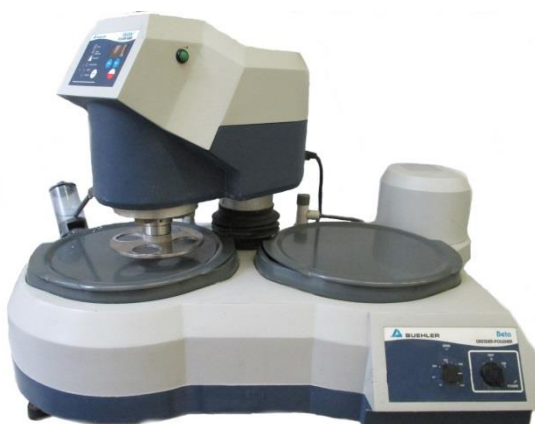
34. Ábra: Csiszoló gép (Buehler Beta)
