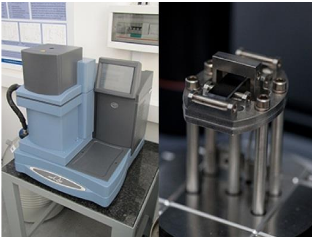
10. ábra DMA Q800 készülék a Polimertechnika Tanszék laboratóriumában [12]
