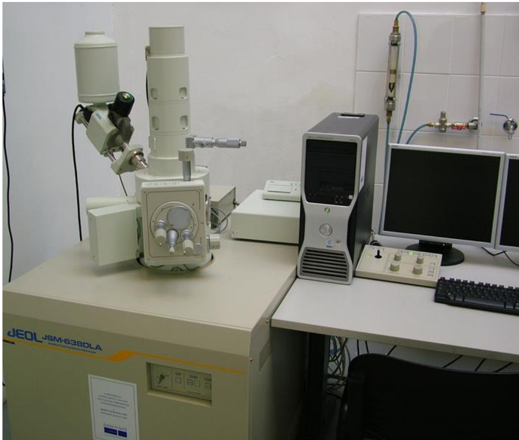
12. ábra Jeol JSM 6380LA típusú pásztázó elektronmikroszkóp [16]
