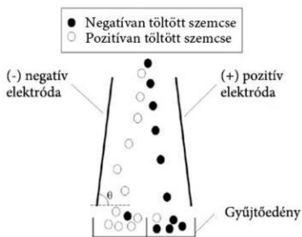
17. ábra Tribo-elektrosztatikus szétválasztás elvi sémája [30]
