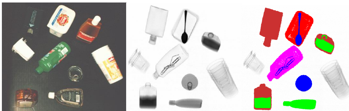
10. ábra Spektroszkópiával történő válogatás [29]
