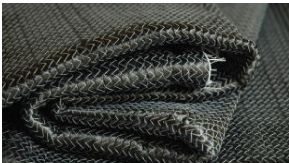
23. ábra Zoltek Panex 35 UD300 típusú fektetett kelme [29]
