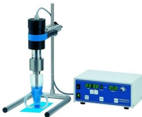
24. ábra Bandelin electronic UW 2200 ultrahangos keverőkészülék [34]
