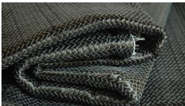
23. ábra: Zoltek Panex 35 UD300 típusú kötött kelme [29].
