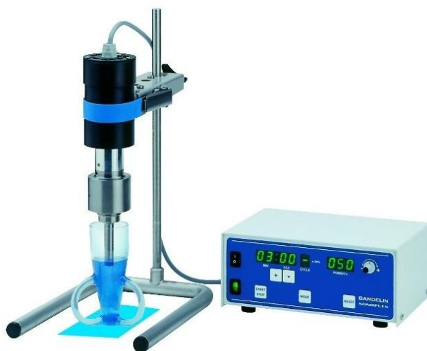
24. ábra: Bandelin electronic UW 2200 ultrahangos keverőkészülék [31].
