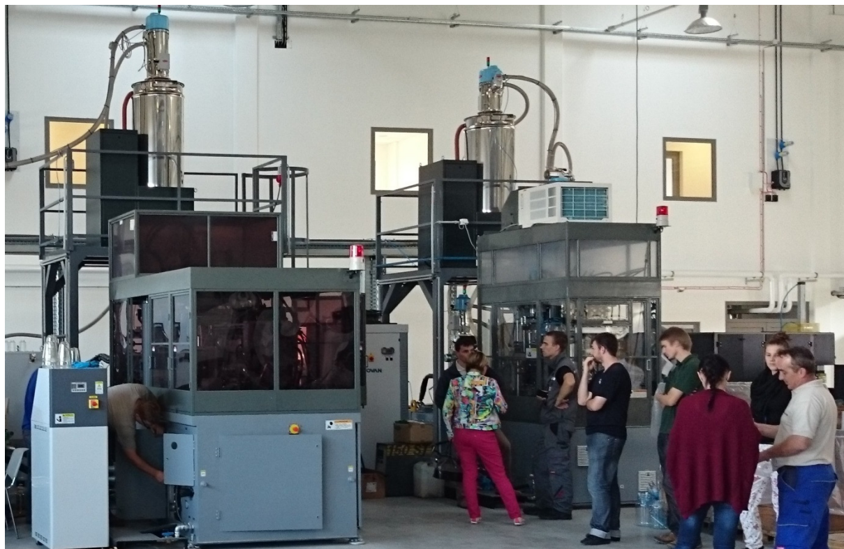
37. ábra A Jász-Plasztik Kft.-nél telepített fröccsfúvó berendezés
