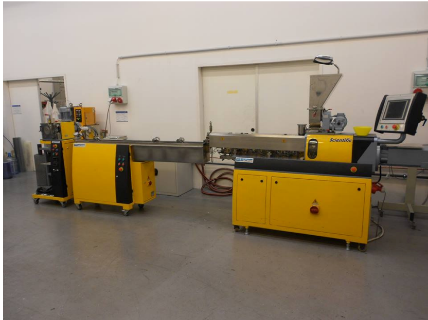
14. ábra Labtech Scientific LTE 26-44 moduláris ikercsigás extruder, Labtech LW-100/L hűtőkád és Labtech LZ-120/VS granuláló
