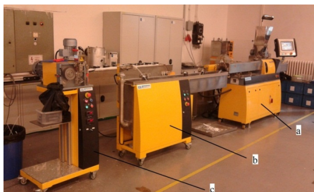
22. ábra: Labtech extrudálósor: (a) extruder, (b) hűtőkád, (c) granuláló készülék
