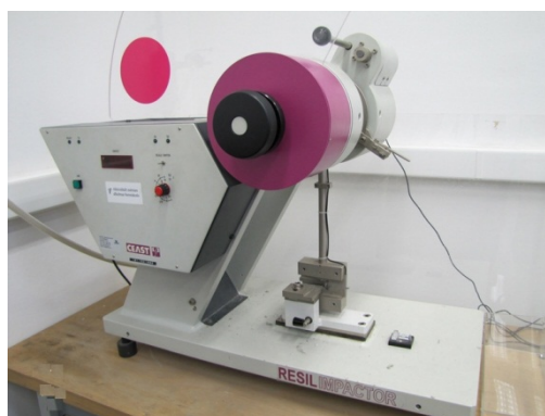
27. ábra: (a) Zwick Z020 típusú univerzális szakítógép, (b) Ceast Resil Impactor Junior típusú számítógép vezérlésű ütőmű DAS 8000 adatgyűjtővel
