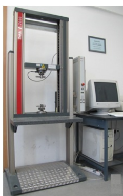
27. ábra: (a) Zwick Z020 típusú univerzális szakítógép, (b) Ceast Resil Impactor Junior típusú számítógép vezérlésű ütőmű DAS 8000 adatgyűjtővel
