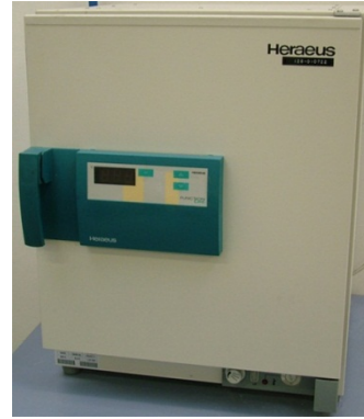
24. ábra: Heraeus UT6 levegőcirkulációs szárítószekrény
