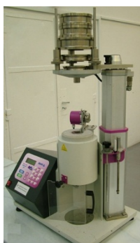
28. ábra: (a) CEA 7027.000 típusú számítógép-vezérlésű kapilláris plasztométer, (b) CAS MWP-1500 típusú mérleg, (c) TA AR2000 típusú rotációs reométer
