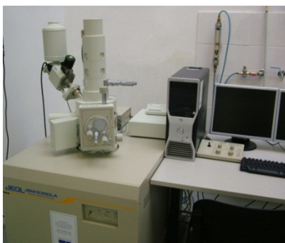
25. ábra: JEOL JSM 6380LA típusú pásztázó elektronmikroszkóp
