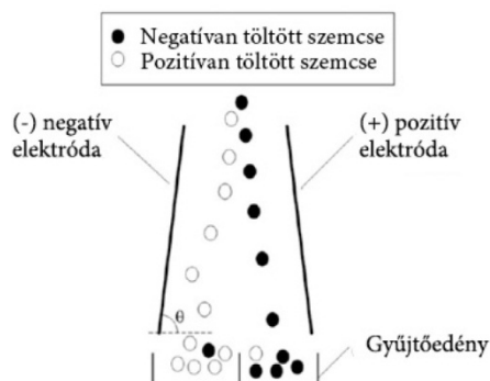
20. ábra: Tribo-elektrosztatikus szétválasztás elvi sémája [36]
