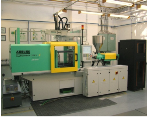
23. ábra: Arburg Allrounder Advance 370S 700-290 típusú fröccsöntő gép
