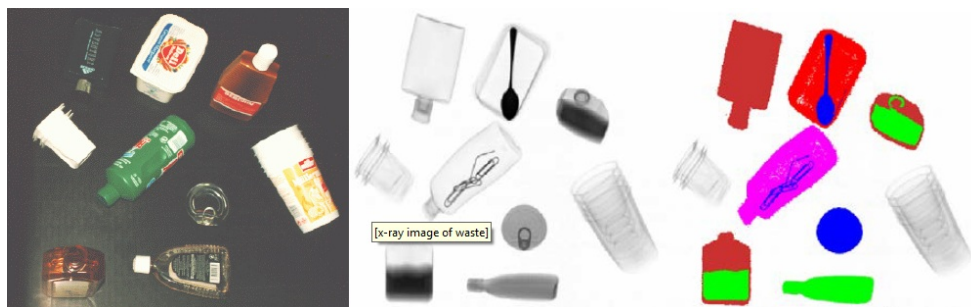
14. ábra: Optikai módszerrel történő szeparálás [34]
