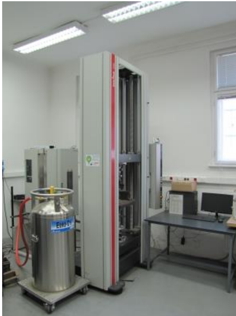
16. ábra Zwick-Z250 típusú szakítógép [16]
