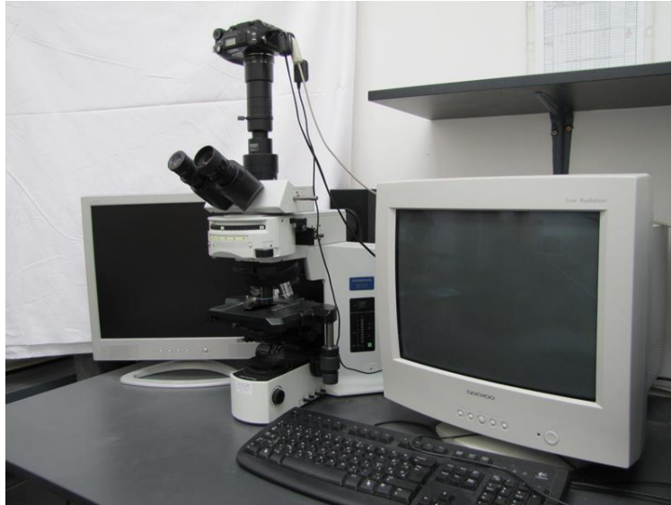
17. ábra Olympus BX 51M típusú optikai mikroszkóp [19]
