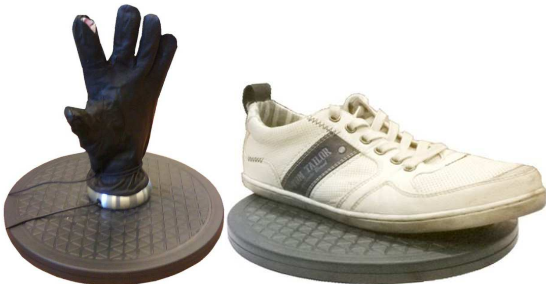
6. ábra Segédeszközök a testrészek pontfelhőinek elkészítéséhez
