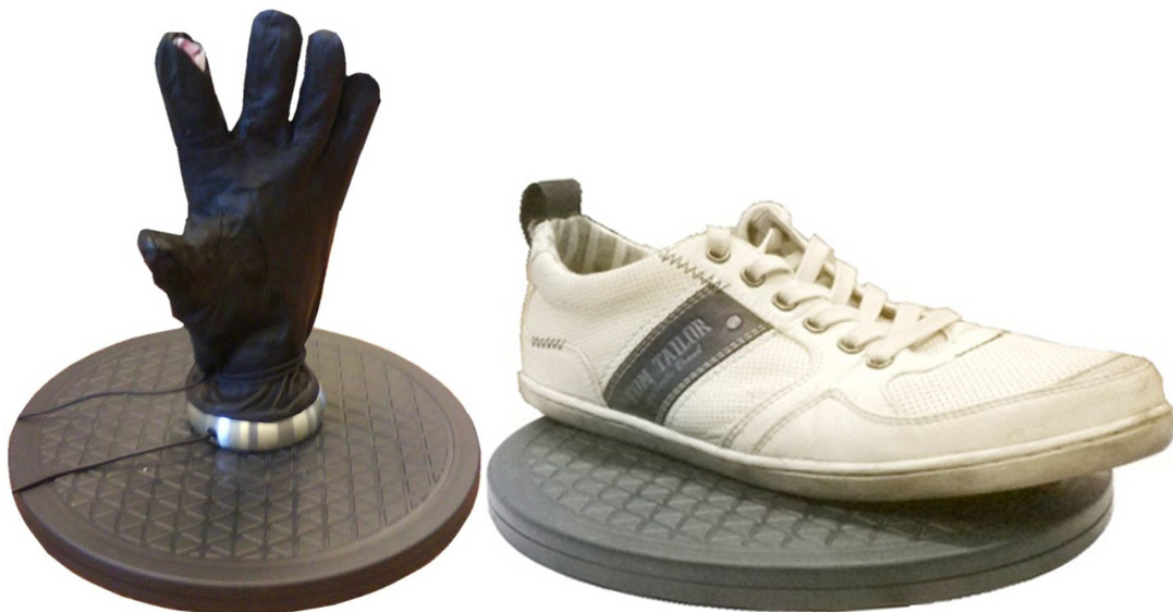
6. ábra Segédeszközök a testrészek pontfelhőinek elkészítéséhez
