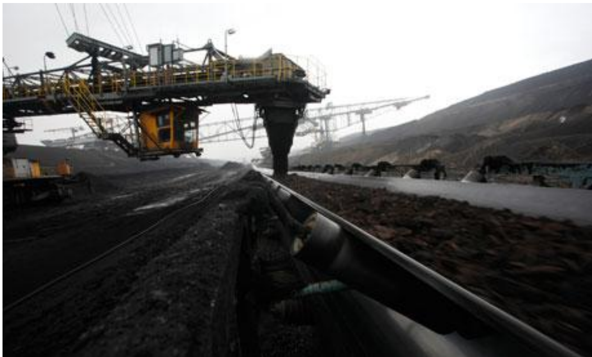
1. ábra: Lignitet szállító szállítószalag
