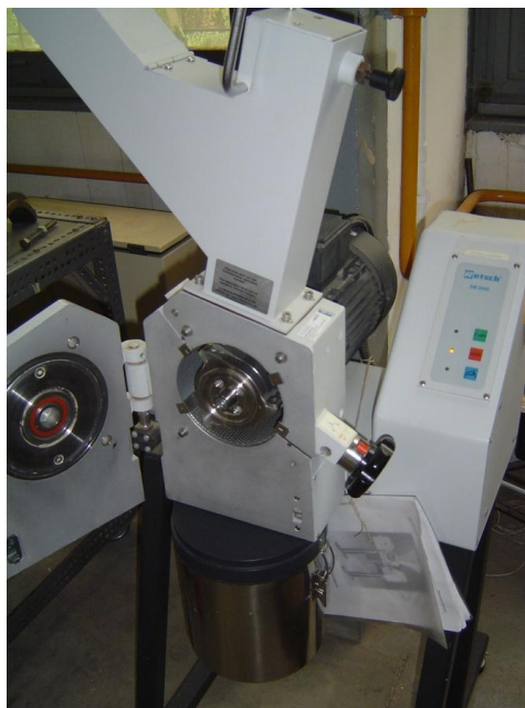
25. ábra: Retsch Heavy-Duty Cutting Mill SM 2000 típusú vágómalom
