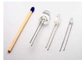
2. ábra: LED-ek (DIP LED) különböző méretben, balról jobbra: 8, 5, 3 mm-es fejmérvével balról (összehasonlításképpen egy gyufaszál)[ledshows.net]
