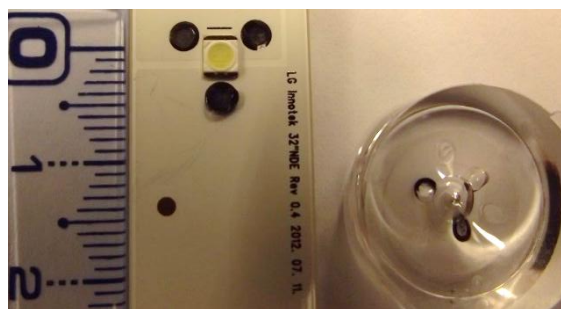
24. ábra: Panelre szerelt Mátrix típusú LG LED és a leszerelt optikája
