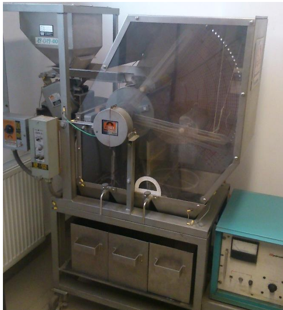
26. ábra: Eriez Magnetics típusú elektrosztatikus dobszeparátor
