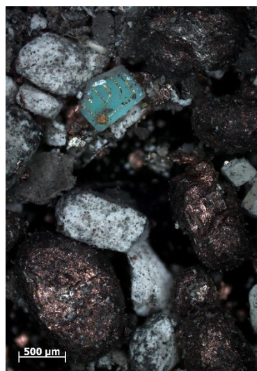
61. ábra: Samsung mátrix LED chip, rézmag és LED töredék (1 mm) szitabetétet használva
