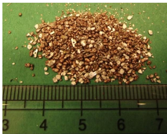
65. ábra: 30 kV-os feszültség mellett: vezető termék (réz)
