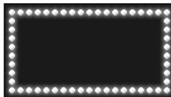
18. ábra: EDGE LED típusú képernyő megvilágítás
