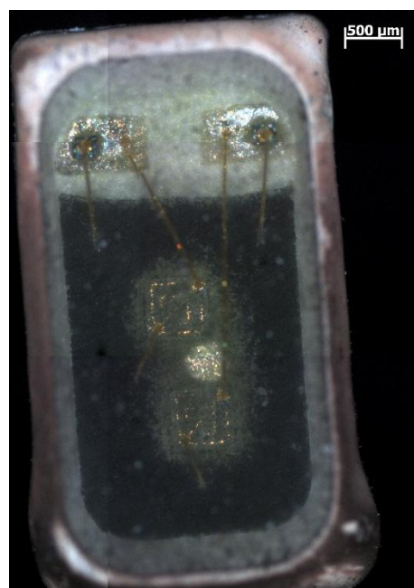
32. ábra: Alulról csiszolt Sony Edge LED felülről fotózva (5x-ös nagyítás)
