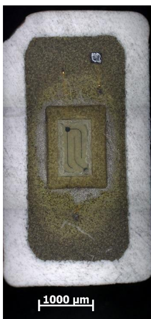
31. ábra: Alulról csiszolt Samsung Edge LED alulról fotózva (5x-ös nagyítás)
