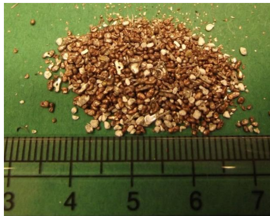
65. ábra: 30 kV-os feszültség mellett: vezető termék (rész)
