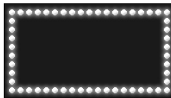
18. ábra: EDGE LED típusú képernyő megvilágítás
