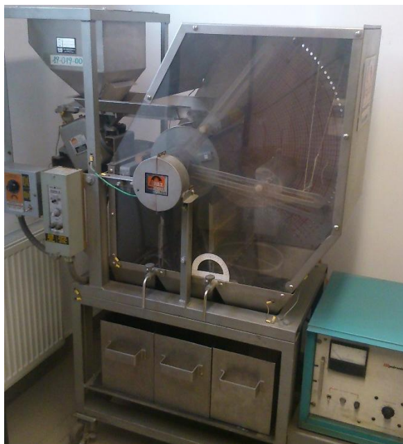
26. ábra: Eriez Magnetics típusú elektrosztatikus dobszeparátor
