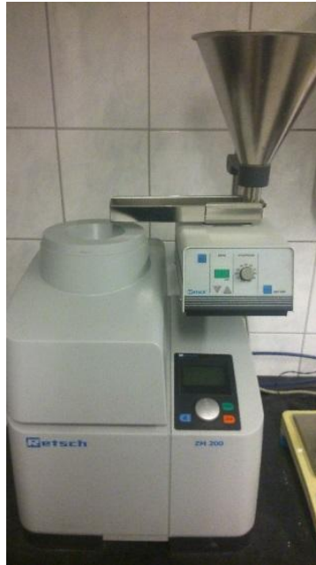
56. ábra: Retsch ZM 200 típusú centrifugál malom
