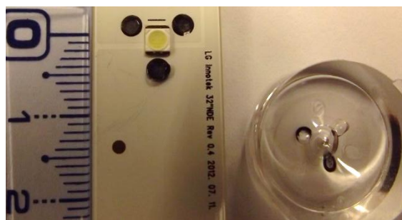
24. ábra: Panelre szerelt Matrix típusú LG LED és a leszerelt optikája
