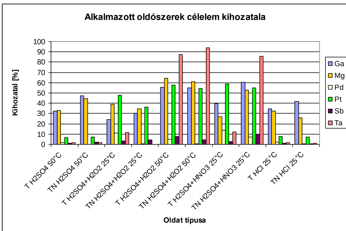
17. ábra: Az alkalmazott oldószerek célelem kihozatala
