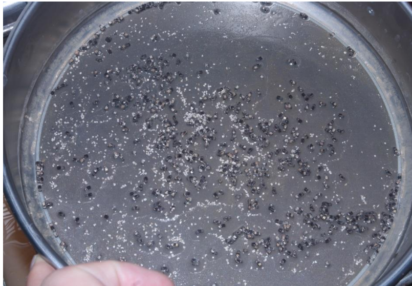
23. ábra : Az oxidált SMD tantál kondenzátor az ultrahangos fürdőt követően
