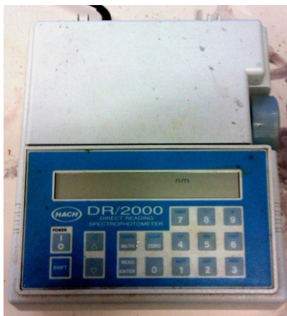
8. ábra – Hach DR/2000 típusú koloriméter (szerző saját készítése)
