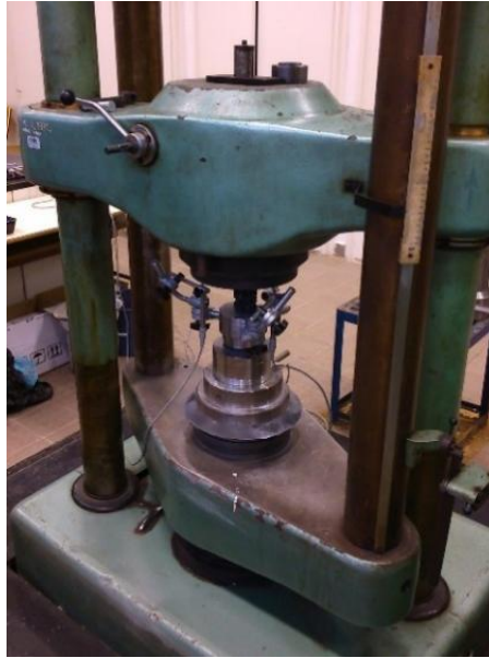
10. ábra Egytengelyű nyomószilárdság vizsgálata
