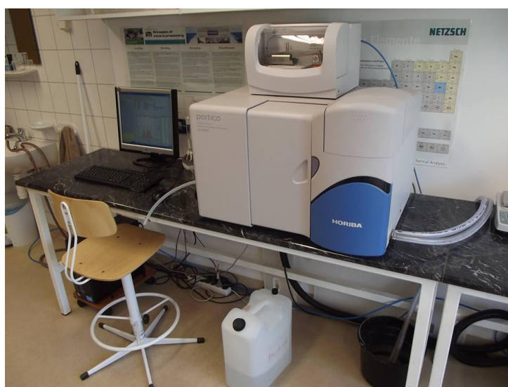
3. ábra Horiba LA-950V2 lézeres szemcseméret-vizsgáló
