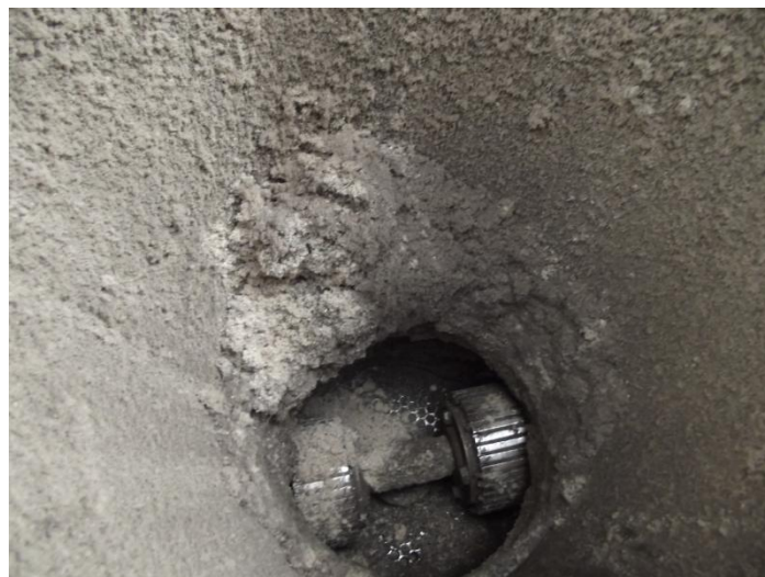
7.3. ábra: Feladó tölcséren történő papírszap feltapadás
