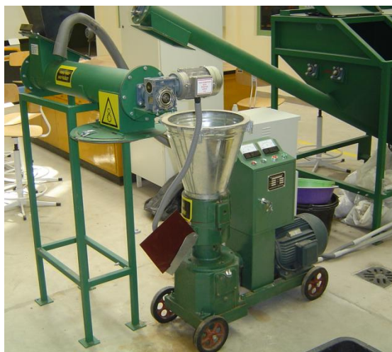
3.4. ábra: Nyersanyagelőkészítési és Környezeti Eljárástechnikai Intézetben található síkmatricás pelletáló rendszer (a: rendszer, b: 200 mm átmérőjű síkmatrica)
