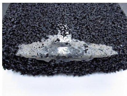
26. ábra: A ferde keverés során készült mintatest a benne szénnyomódott röggel
