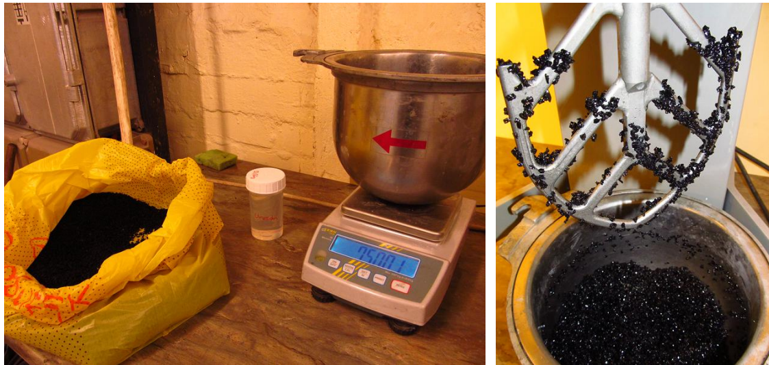
29. ábra: A keverék komponenseinek bemérése és bekeverése
