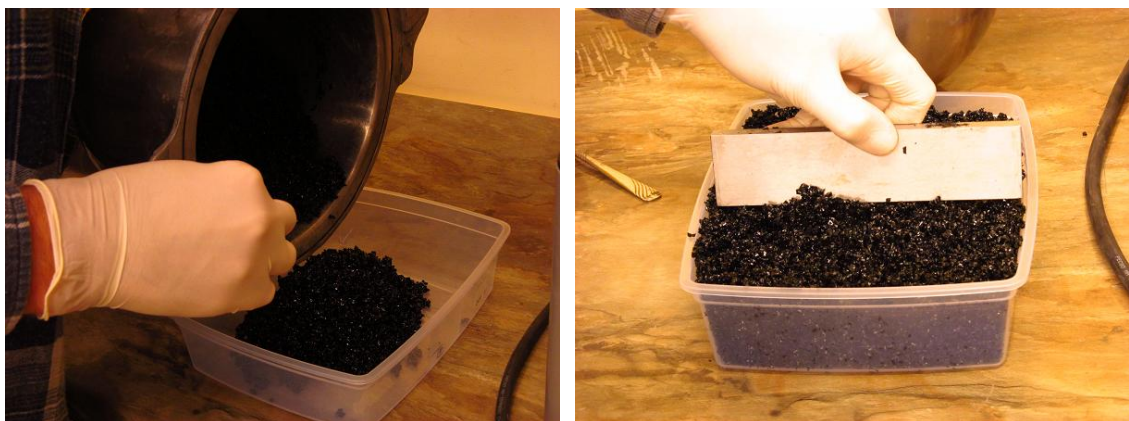
30. ábra: A keverékek mintatestbe öntése és tetejének elsimítása
