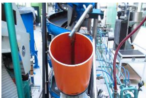
25. ábra: A vizsgálatokhoz kialakított ferde tengelyű keverő
