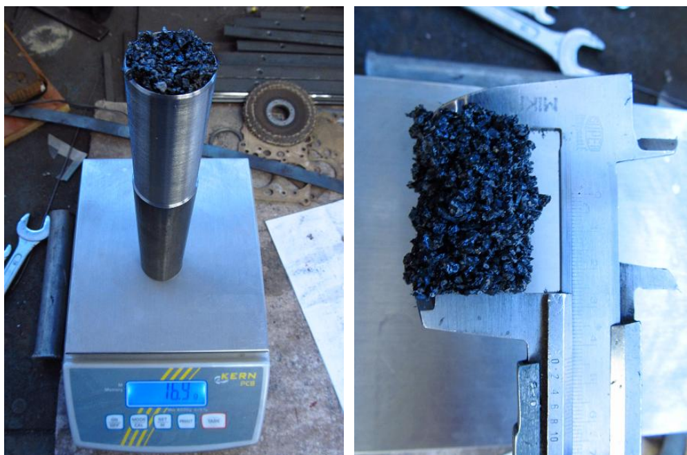
34. ábra: A rész minta mérlegelése és magasságának megállapítása
