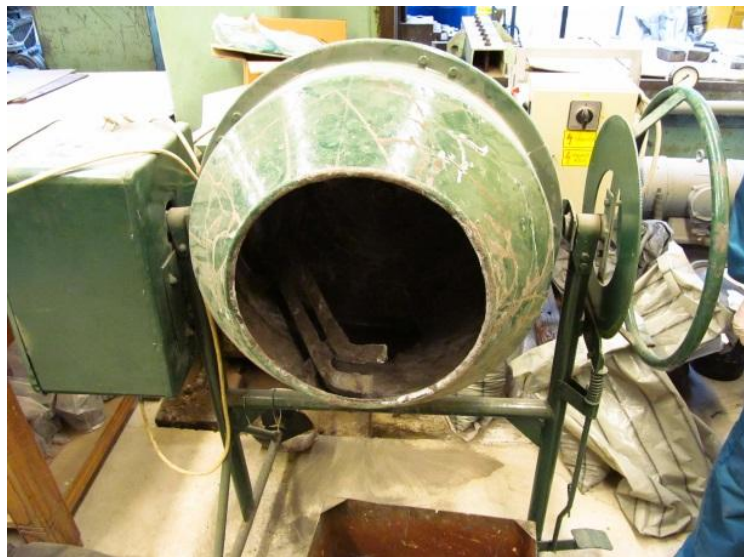
13. ábra: A ferde tengelyű, két „lapátos” betonkeverő
