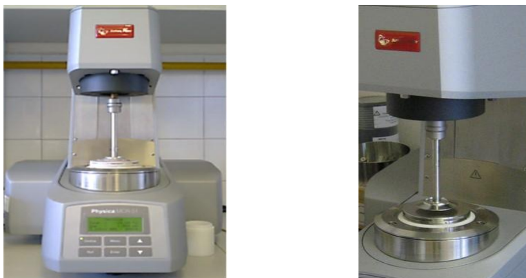
3. ábra Physica MCR51 viszkoziméter és lap-lap mérőrendszer
