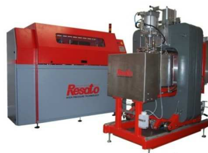
8. ábra: Nagynyomású berendezés (Forrás: BCE-ÉTK-HÁT)
