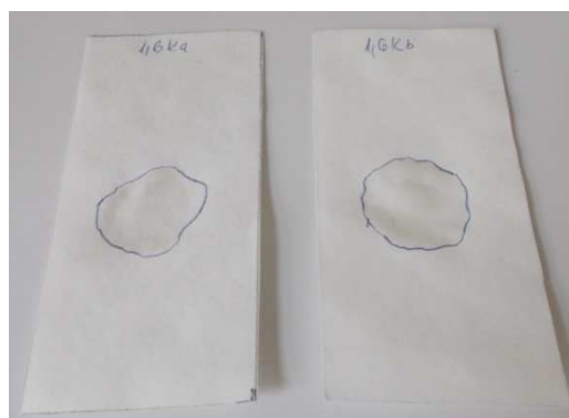
11. ábra: Vízirtó képesség mérésére használt szűrőpapír (Forrás: saját fotó)
