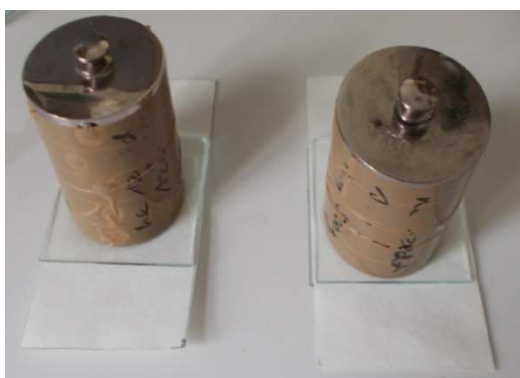
10. ábra: Vízirtó képesség mérése (Forrás: saját fotó)
