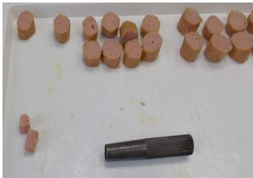
12. ábra: Próbatestek kivágása (Forrás: saját fotó)
