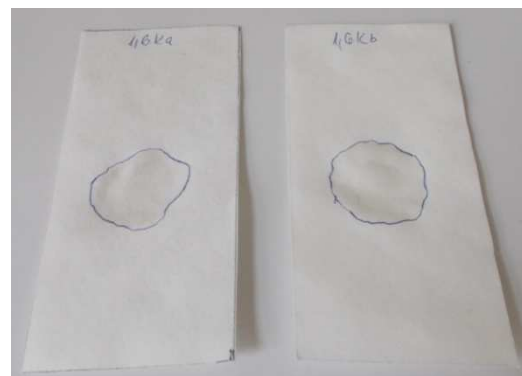
11. ábra: Vízirtó képesség mérésére használt szűrőpapír (Forrás: saját fotó)
