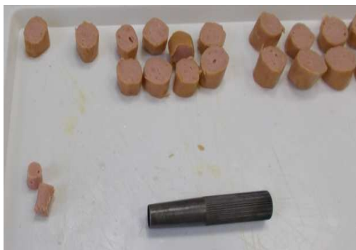
12. ábra: Próbatestek kivágása (Forrás: saját fotó)
