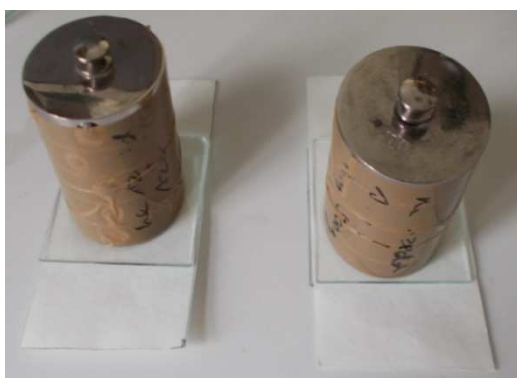
10. ábra: Vízirtó képesség mérése (Forrás: saját fotó)
