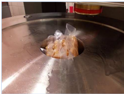
8. ábra: Virsli kezelése HHP berendezés hüvelyében (Forrás: sajátfotó)
