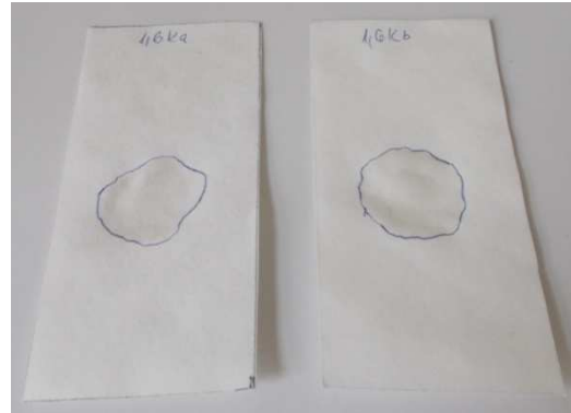
12. ábra: Víztartó képesség mérésére használt szűrőpapír (Forrás: saját fotó)
