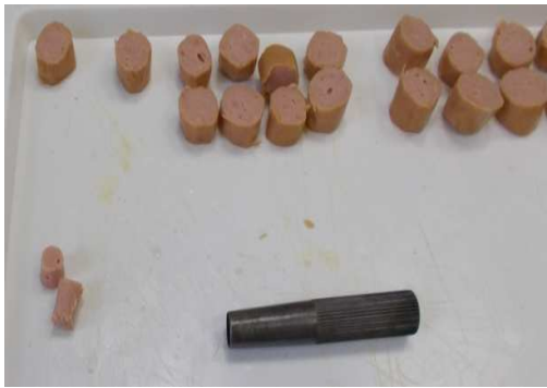
13. ábra: Próbatetek kivágása (Forrás: saját fotó)
