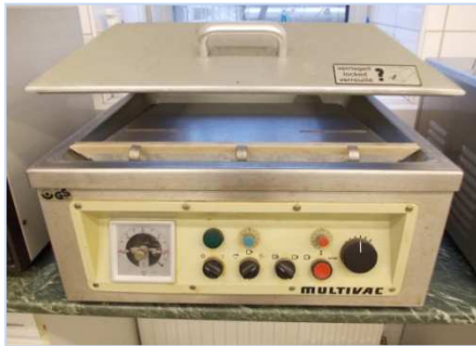
6-7. ábra: Multivac berendezés és a vákuumcsomagolt virsli (Forrás: BCE-ÉTK-HÁT; saját fotó)
