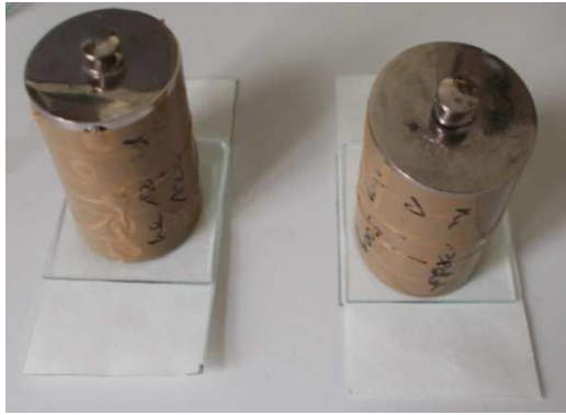
11. ábra: Víztartó képesség mérése (Forrás: saját fotó)
