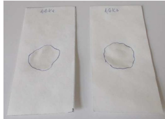
12. ábra: Víztartó képesség mérésére használt szűrőpapír (Forrás: saját fotó)
