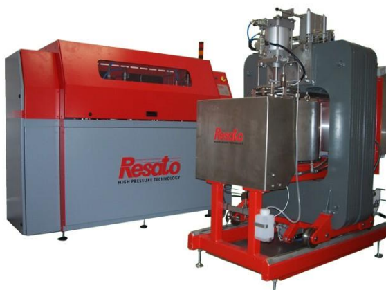
7. ábra: RESATO FPU 100-2000 laboratóriumi HHP berendezés (forrás: „Resato FPU 100-2000...”, 2009)
