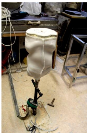
2.11. ábra: Polietilén formázása torzón
