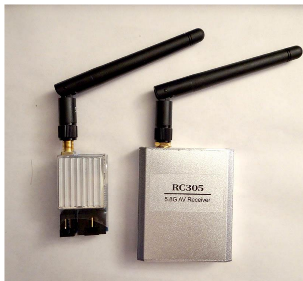
6.22. ábra: Boscam 5.8Ghz-es 200mW-os adó vevő egység
