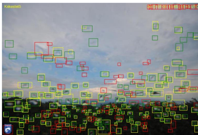
4.8. ábra – Esőcseppek detektálásának a kiértékelése. Zöld négyzetek az elvárt eredményeket jelölik, a sárgák pedig az algoritmus eredményeit. Ez utóbbiakból pirossal lettek jelölve azok a területek, amelyeket a rendszer rosszul ismert fel.
