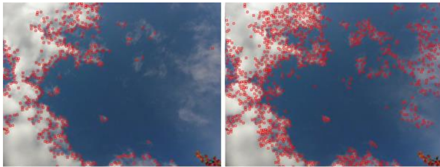
3.3. ábra – Sarokpont detektorok alkalmazása felhős képen. Balra a Harris-féle sarokpont detektor, jobbra a minimális sajátértékkel számolt módszer.
