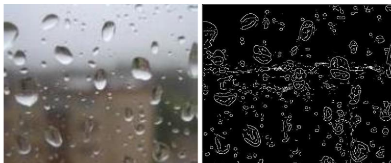
4.4. ábra - Éldetektálással végzett esőcsepp detektálás előfeldolgozásának az eredménye.
