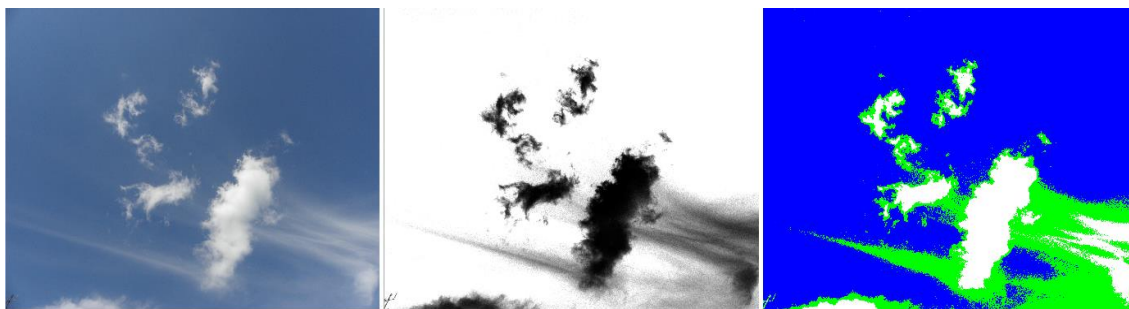
2.12. ábra – Eredeti kép, szaturációs kép, küszöbölt kép – kék: ég, fehér: felhő, zöld: nem besorolt
