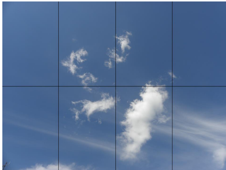
2.1. ábra - Égbolt borultságának meghatározása becsléssel, képzeletbeli rács használatával. A kép alapján becsült érték 3 okta [2].
