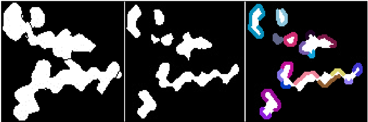
19. ábra Minimális terület vágást hajtunk végre (bal), majd előfeldolgozást (közép) és konvex görbe meghatározást (jobb) végzünk
