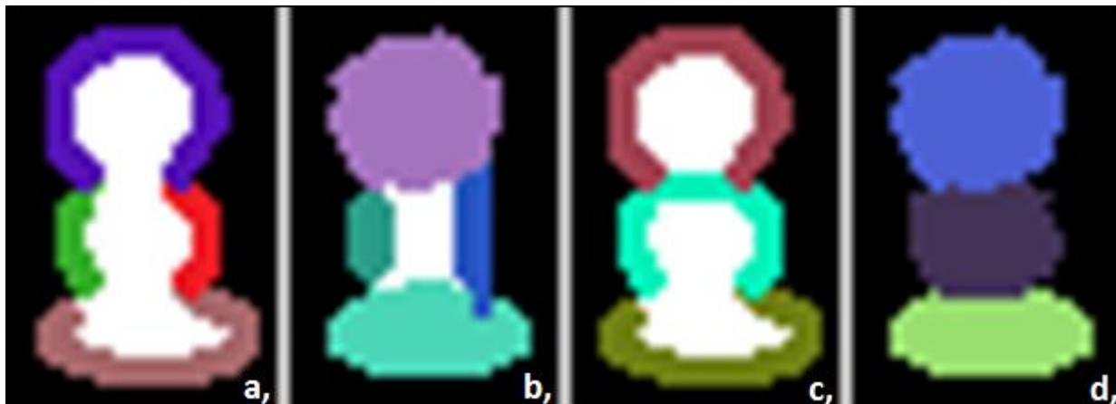
20. ábra a, konvex görbék, görbe vizsgálat nélkül b, hibásan meghatározott ellipszisek c, konvex görbék, görbevizsgálattal d, helyesen meghatározott ellipszisek
